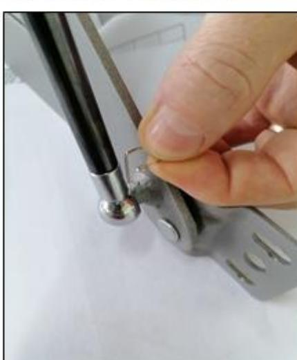
3. Установить фиксаторы на крепления газлифта.
