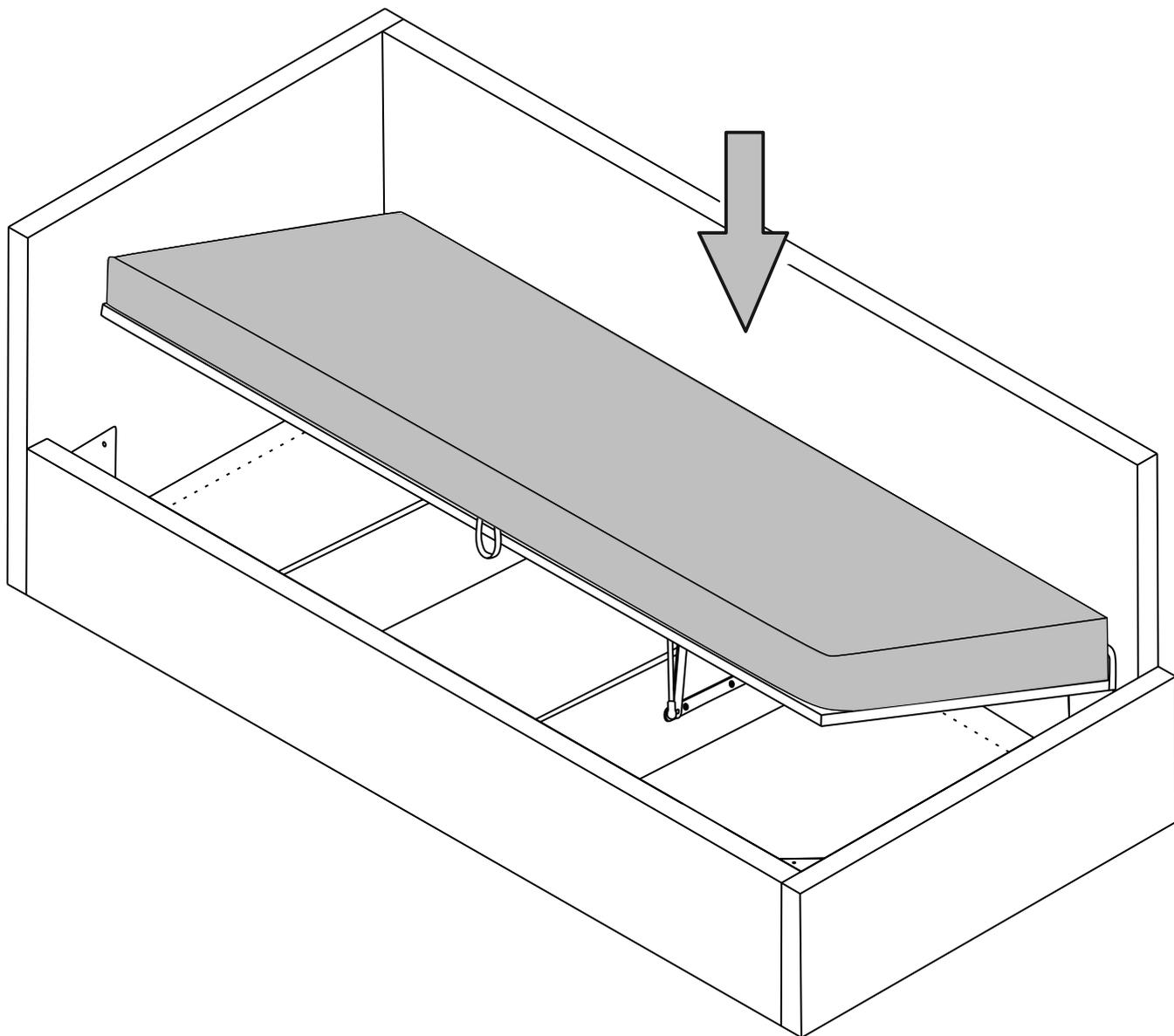
Эксплуатация подъемного механизма без матраса не допускается!
