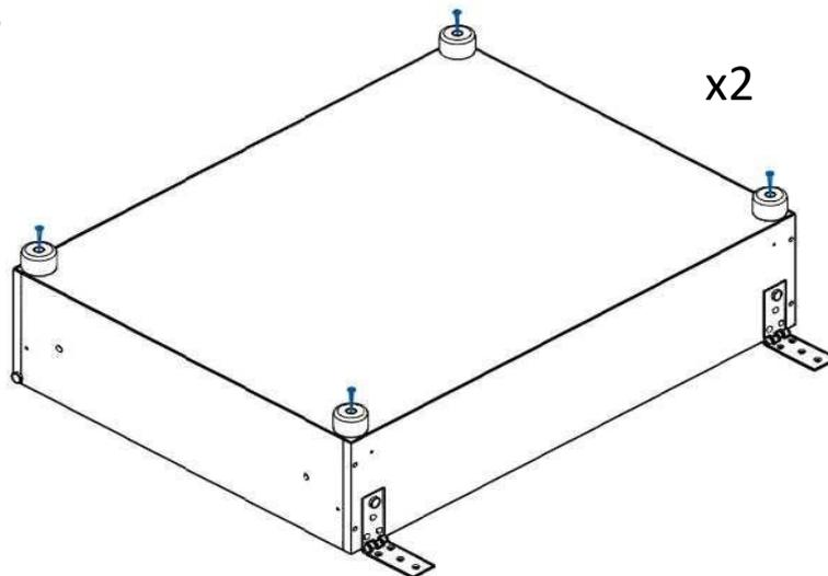
5. Установить подножку 168 -2шт.на переднюю панель бельевого ящика дивана с помощью саморезов 5x30-4шт. Рис.4
