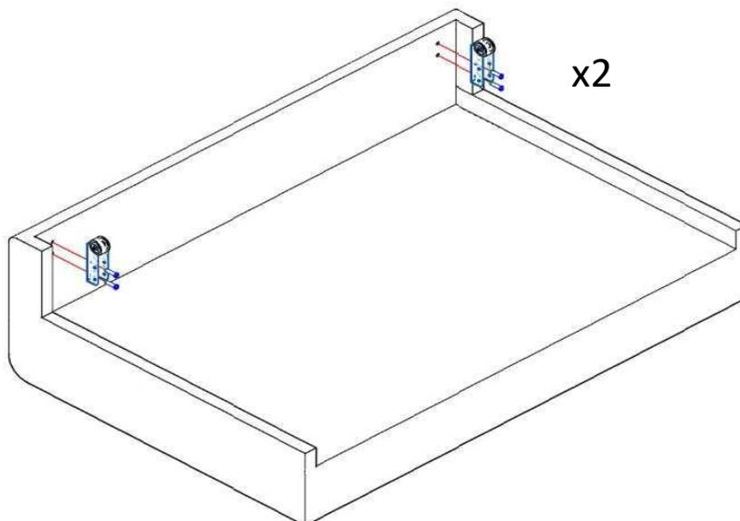
4. Снять транспортировочные уголки и картон. Установить опоры круглые 35мм. на дно короба по разметке с помощью саморезов 5x30.
