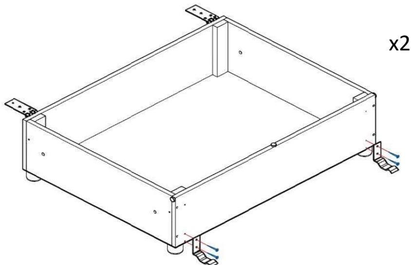
6. Установить на бельевой ящик спинку дивана (№2) и закрепить с помощью винта М6х20-4шт.и саморезов 4х16-4шт. Рис.5
