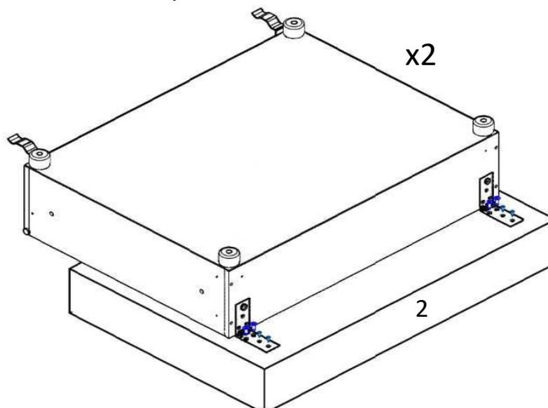
7. Поставить бельевые ящики с установленными спинками на опоры. Соединить между собой через проставочные межсекционные бруски (№5) с помощью шпильки М8х135-2шт. Шайбы 8-4шт. И гайки М8 колпачковой.
