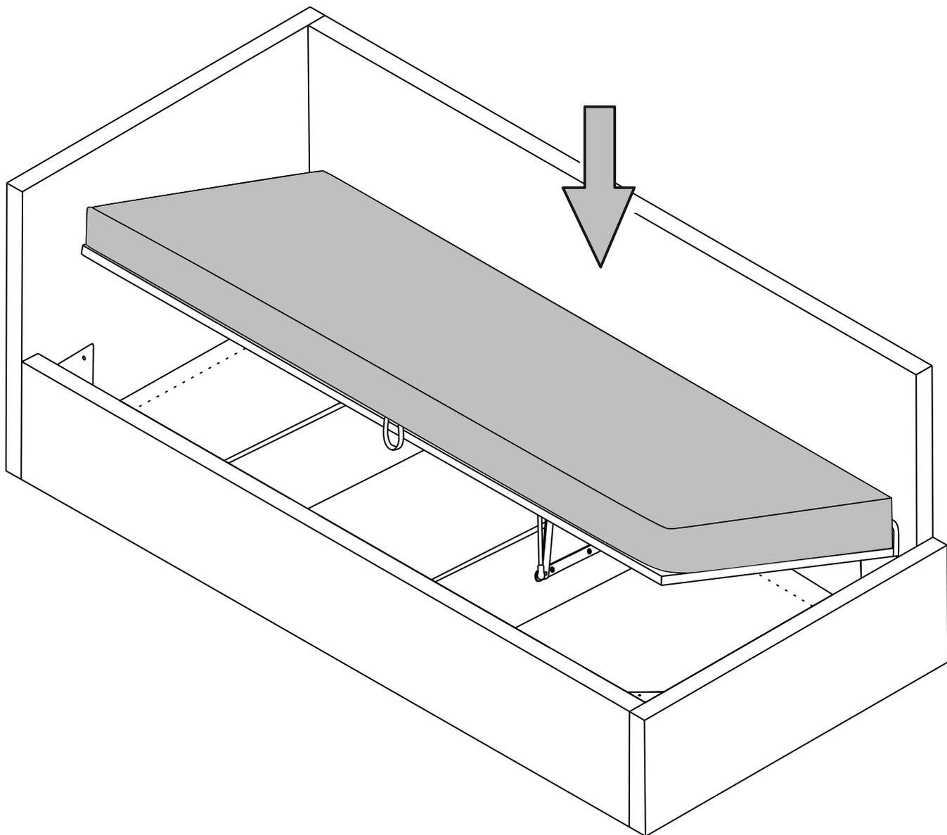
Эксплуатация подъемного механизма без матраса не допускается!
