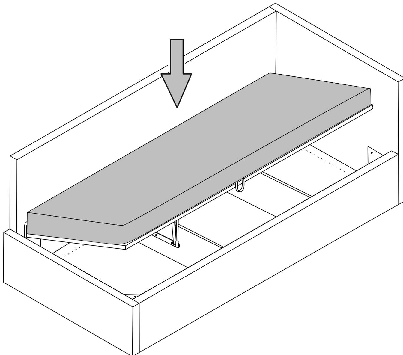
Эксплуатация подъемного механизма без матраса не допускается!
